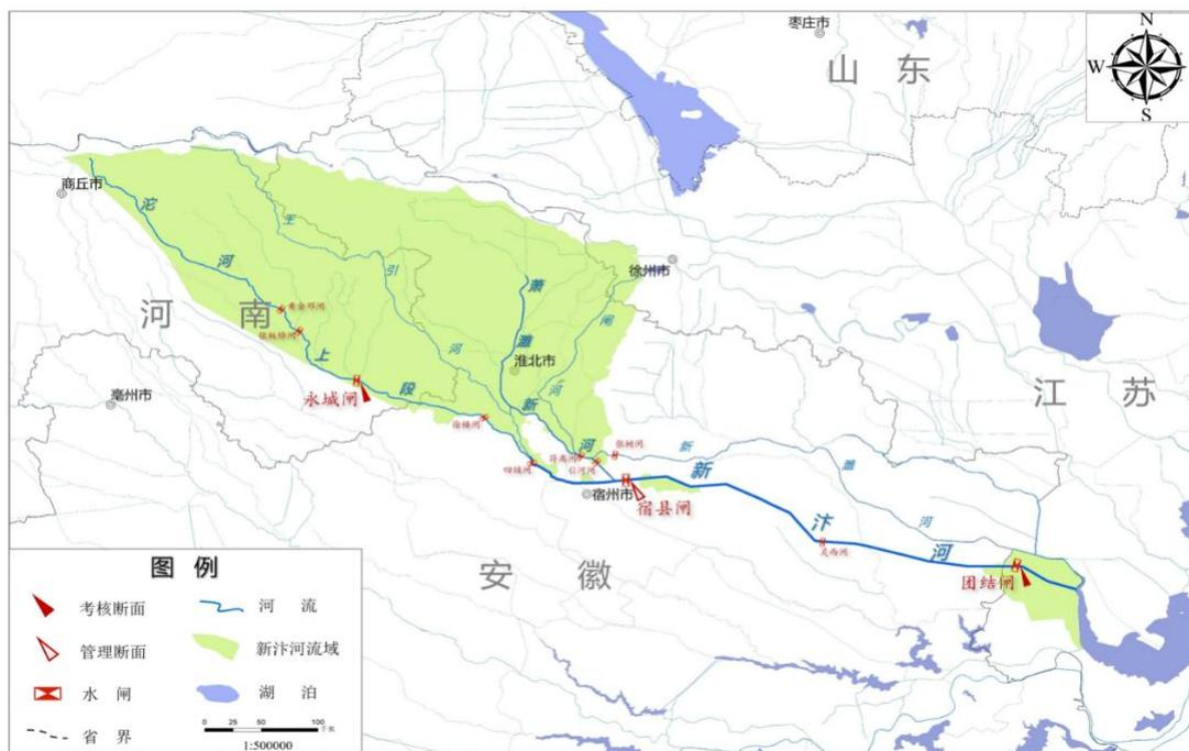
图 2-3 新汴河生态水量主要控制断面和重要工程分布图
